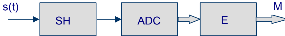
Fig. A1 Struttura base di un sistema di misura basato sull'elaborazione numerica dei segnali
